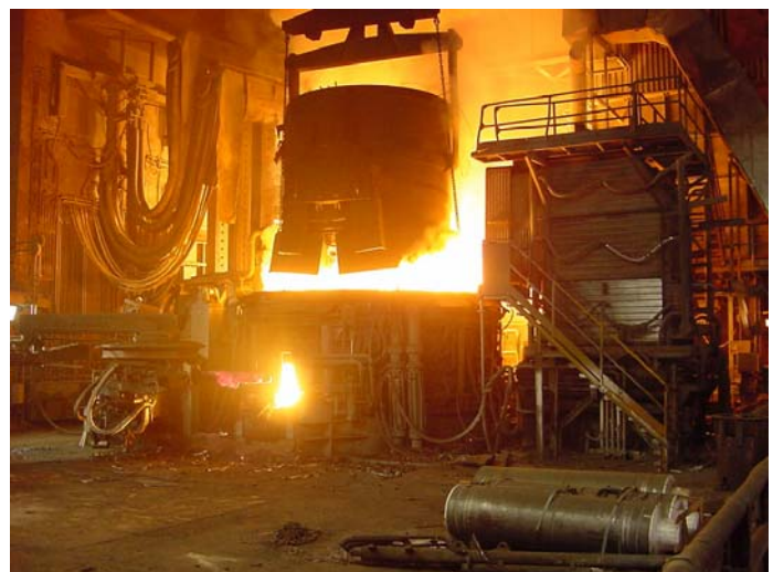
Figura 1 _ Forno elettrico ad arco (EAF), fase di caricamento del rottame.
