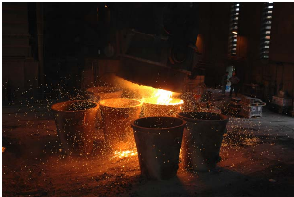
Figura 3_ Svuotamento dei residui acciaio scoria dopo il colaggio
